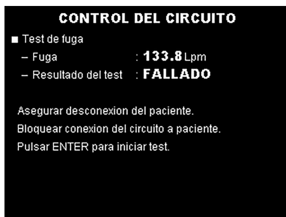
Figura F-7. Control del circuito (completo, fallado)
