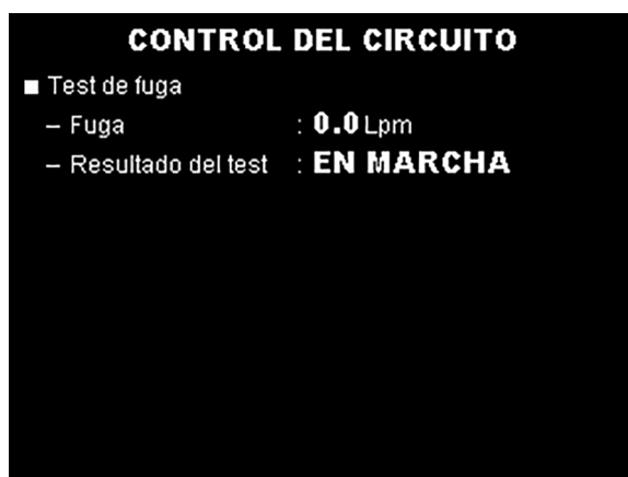
Figura F-5. Control del circuito (en marcha)
